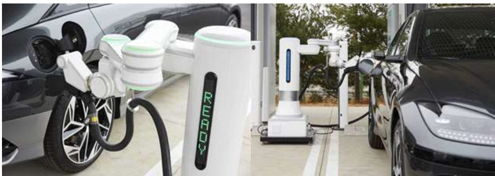
[ 그림 10 ] 인천국제공항 AI 기반 전기차 자동충전 로봇(현대자동차그룹 제공)
