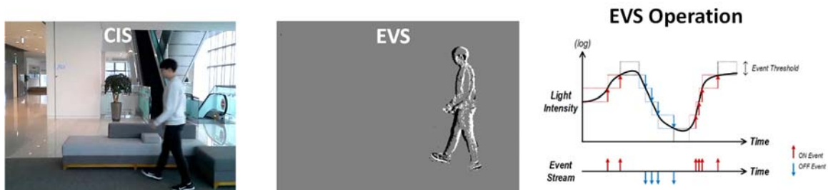
그림 6-5. EVS와 CIS의 차이와 EVS의 기본 동작 방식
